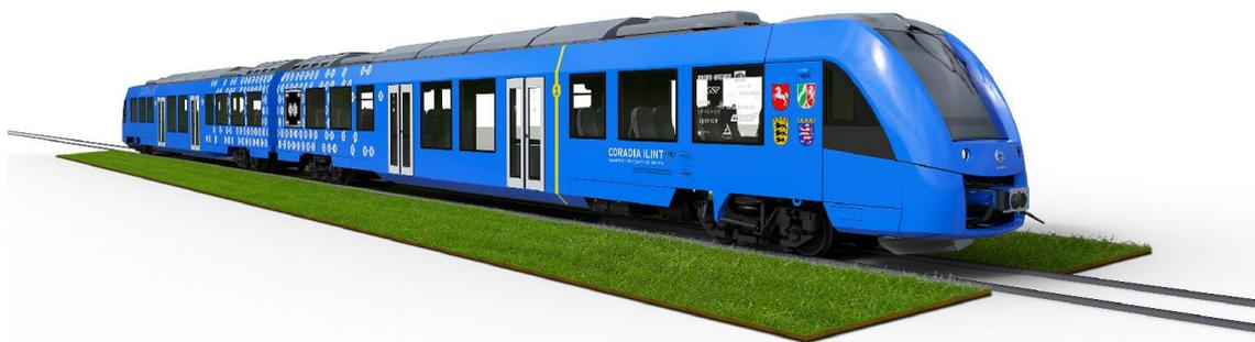
Coradia iLint è speciale per la sua combinazione di diversi elementi innovativi; conversione all'energia pulita, immagazzinamento flessibile dell'energia e gestione intelligente della potenza di trazione e dell'energia disponibile. Oltre a essere ecologico, l'idrogeno offre molti più vantaggi: è disponibile e ha un prezzo competitivo, essendo uno degli elementi più abbondanti nell'universo.
